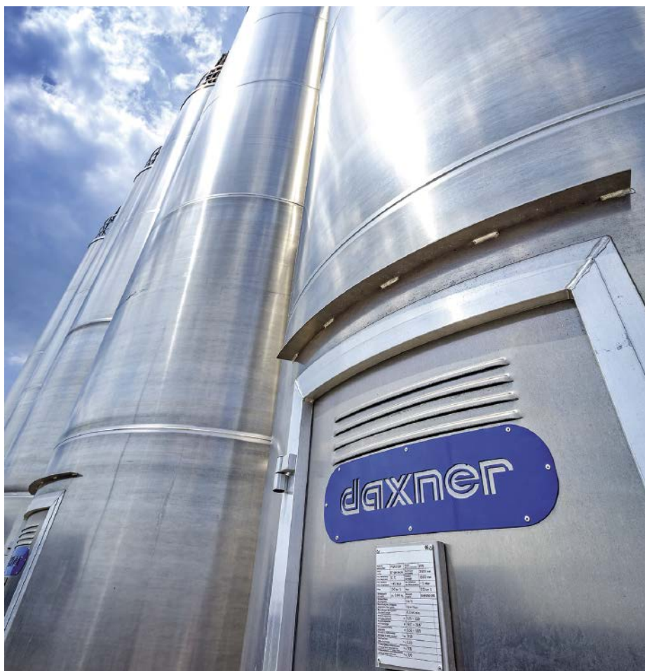
■ Abb. 2: Lagerung der Großkomponenten in Außensilos inklusive Fail-Safe Beschickungs-System durch Tankwagen, Silokopfraumtrocknung und eine gleichzeitige Förderung und Dosierung auf bis zu sechs separate Mischlinien.
