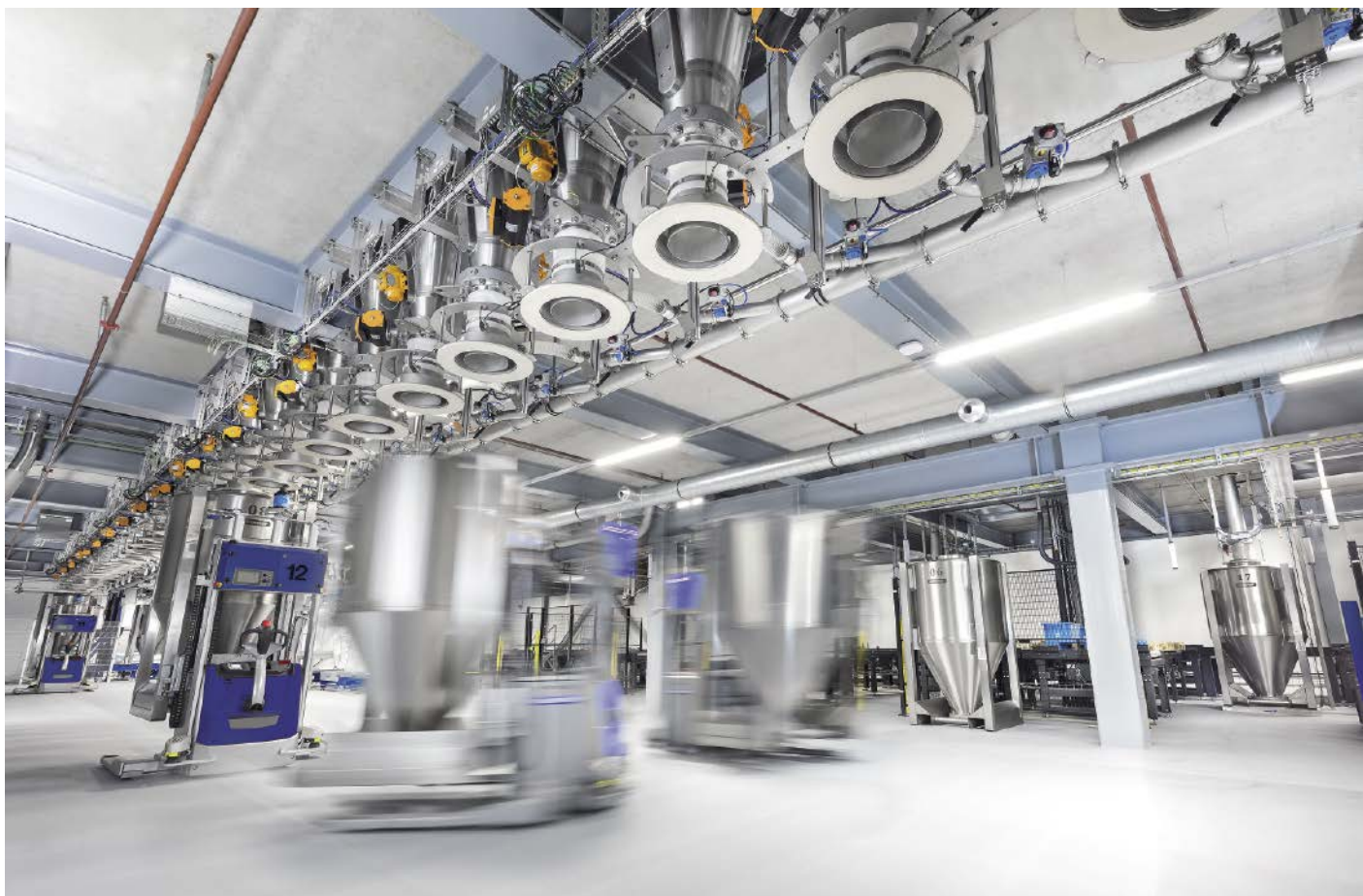
■ Abb. 4: Der Transport der Container im Daxner Container System DCS erfolgt von konventionellen Rollen- und Kettenbahnen über abgehängte Systeme, Portalkranlösungen, lasergesteuerte fahrerlose Transportsysteme (FTS) bis hin zu mehrdimensionalen Container-Transportsystemen mit integrierter Hubeinrichtung (Regalbediengerät RBG).
