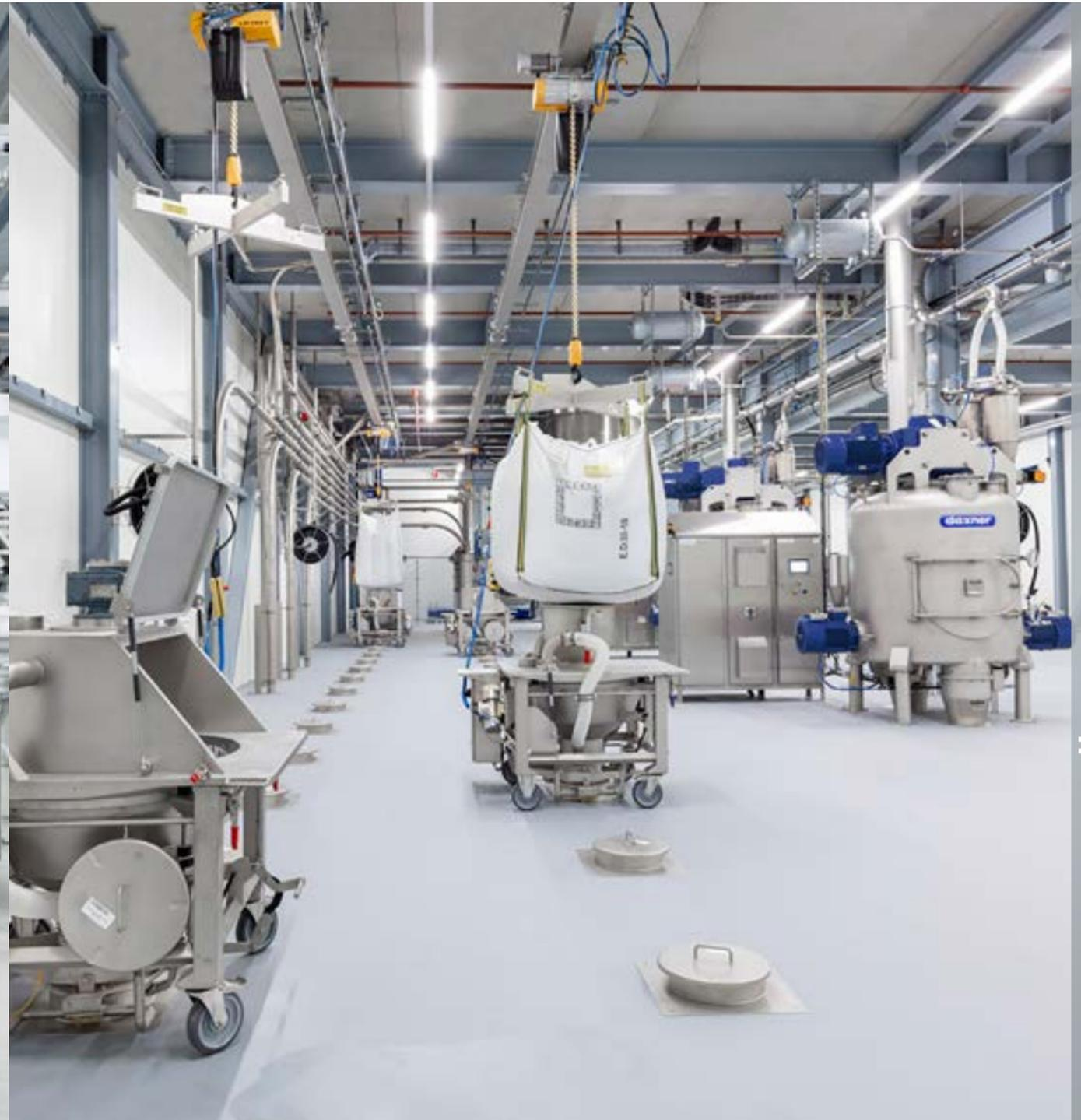
Mobile Sack- und Big-Bag-Entleerstationen mit Kontrollsiebung (VIB & PRESS Technologie) zur Befüllung der Rohstoffe in die Tagessilos, wo sie in automatisierte Dosier-, Förder- und Mischsysteme (Hochleistungs-Vertikal-Mischlinie in CIP-Ausführung) aufgegeben werden, gewährleisten Leistung, Flexibilität und Hygienic Design.
