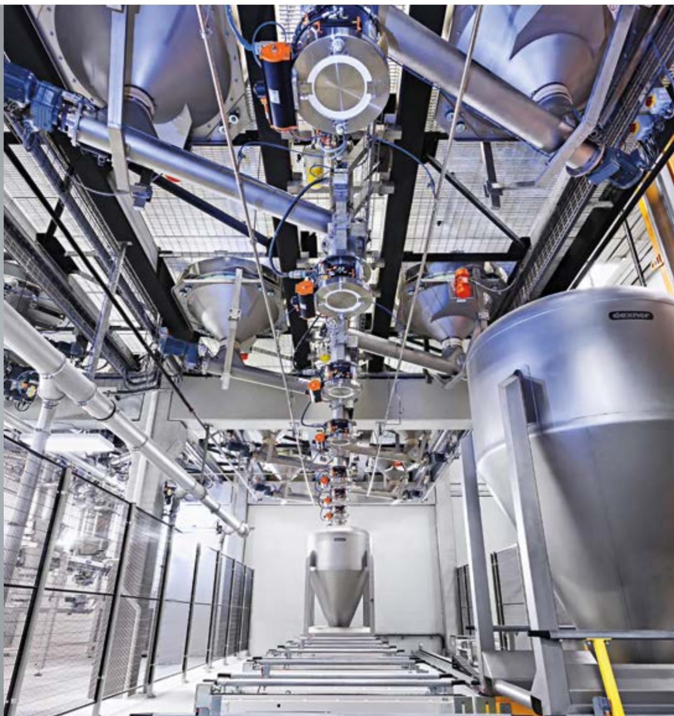
Kompromisslos hygienisches Design in einer Backmittelmischanlage. Ein vollautomatisches, dreidimensionales Containertransportsystem ermöglicht eine große Durchsatzleistung, hohe Dosiergenauigkeiten und ein allergenfreies Handling von Komponenten. Das automatische CIP-Reinigungssystem (Nassreinigung) der Mischanlage minimiert sowohl Reinigungsdauer als auch Reinigungsaufwand und maximiert somit die Anlagenverfügbarkeit.
