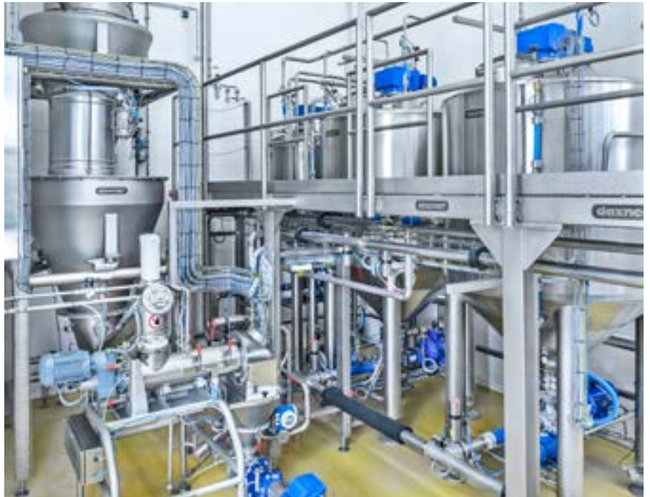
Kontinuierlicher Anteiger daxDou zur Herstellung von Vorteigen
