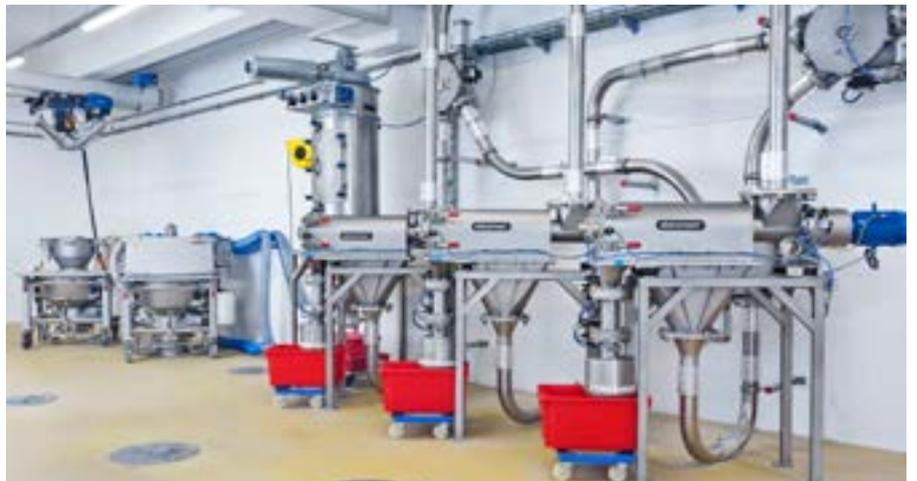
Inline Siebmaschinen mit Sackschütte u. Big-Bag Entleerstation
