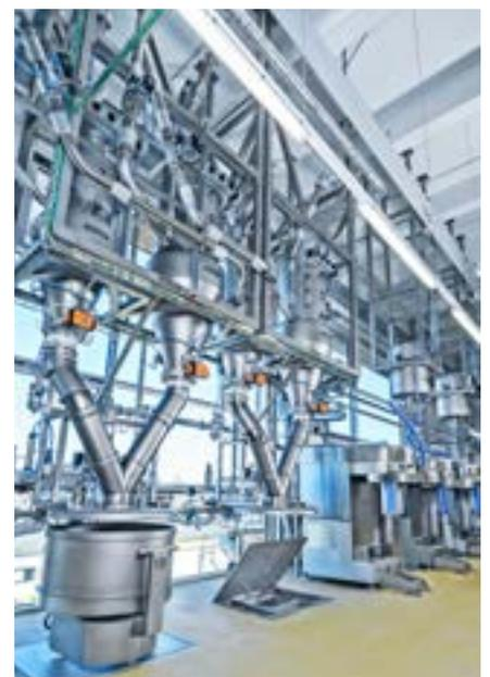
Zentrale Mehl- und Komponentenverwiegestation mit Knetsystemen
