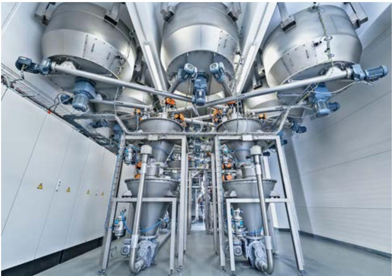
Autom. Mittelkomponentenanlage mit Wiegesystem
