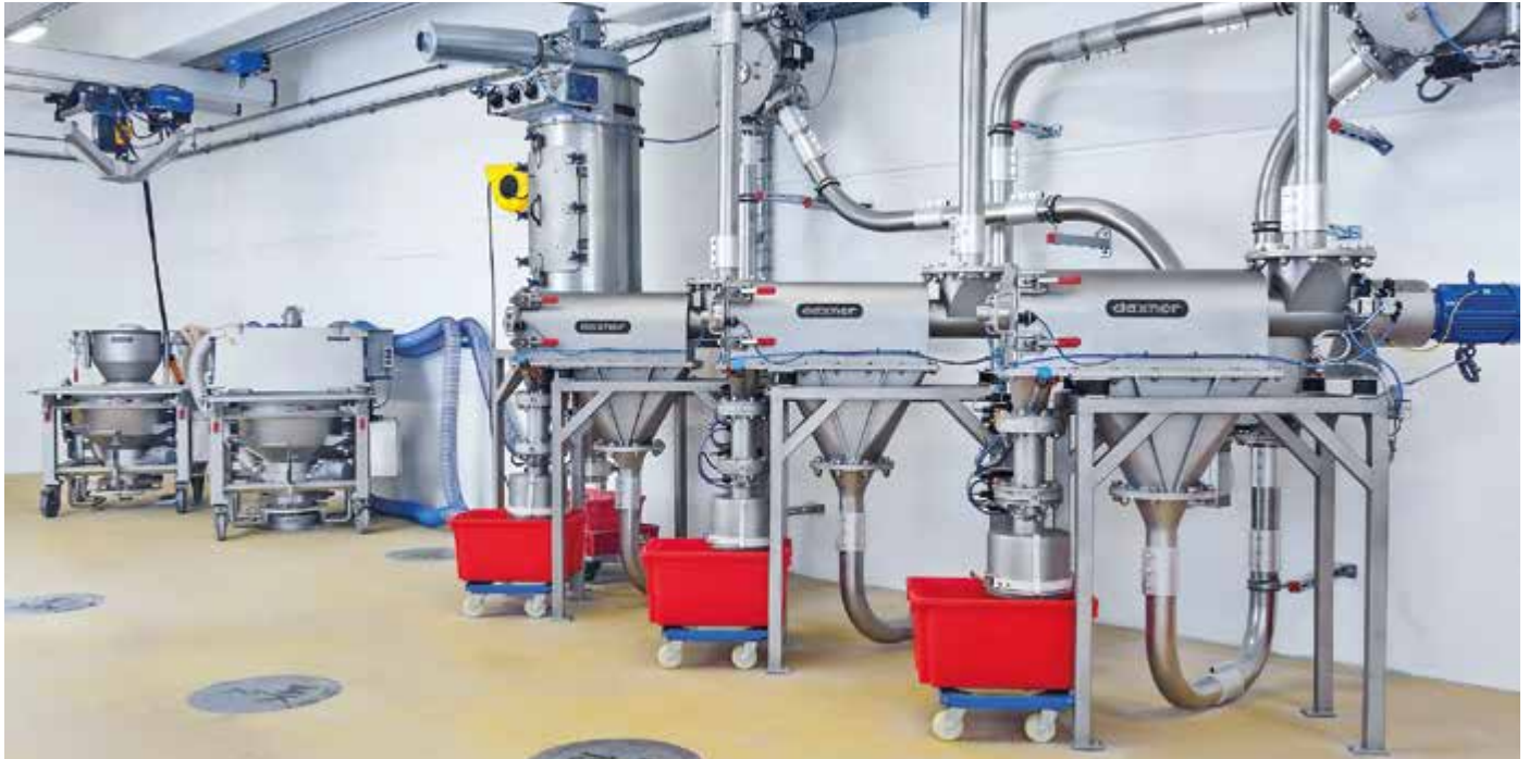
Inline-Siebmaschinen mit Sackschütte und Big-Bag-Entleerstation
