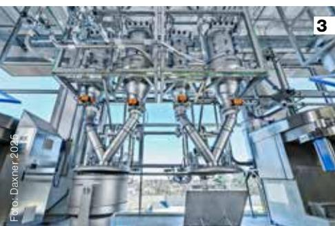
**1** Die automatische Mittelkomponentenanlage ist mit einem Wiege- und Fördersystem ausgestattet. **2** Für die rationelle Auffüllung der Zutatensilos stehen Inline-Siebmaschinen mit Sackschütten und Big-Bag Entleerstation bereit. **3** Die zentrale Mehl- und Komponentenverwiegestation ist für eine hohe Rezepturtreue mit einer Bodenwaage ausgestattet. **4** Die Mehl- und Komponentenverwiegestation befindet sich in der Mitte der Knetsysteme mit fahrbaren Kesseln.
